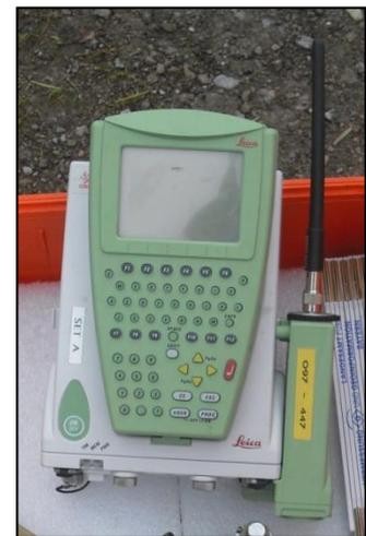
Abbildung 2.2: Leica Receiver GX1230 GG mit Modem
