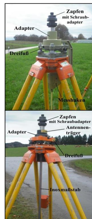
Abbildung 2.4: Stative mit Aufbau
